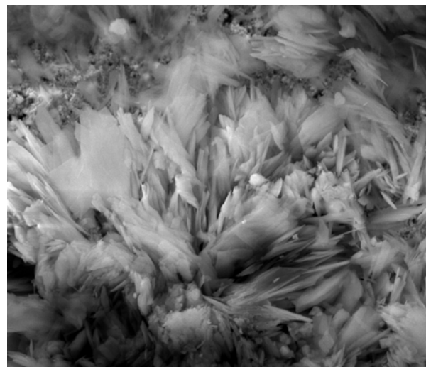
Рис. 3. Растровое изображение чувствительного слоя ( \text{SnO}_2 ) полупроводникового адсорбционного датчика с увеличением \times 50000
